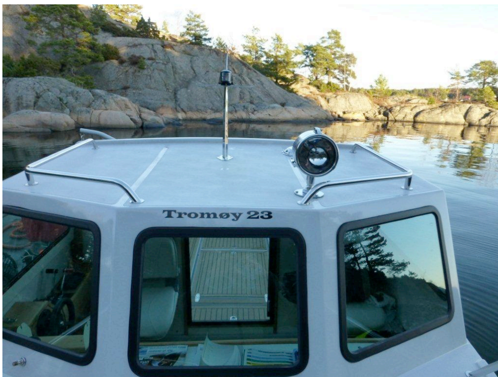
Norskproduserte ( www.ertec.no ) vinduer og dør med farget og herdet glass og elokserte aluminiumsprofiler. Norskproduserte syrefaste takrekker ( www.suntec.no ) er ekstraustyr.
