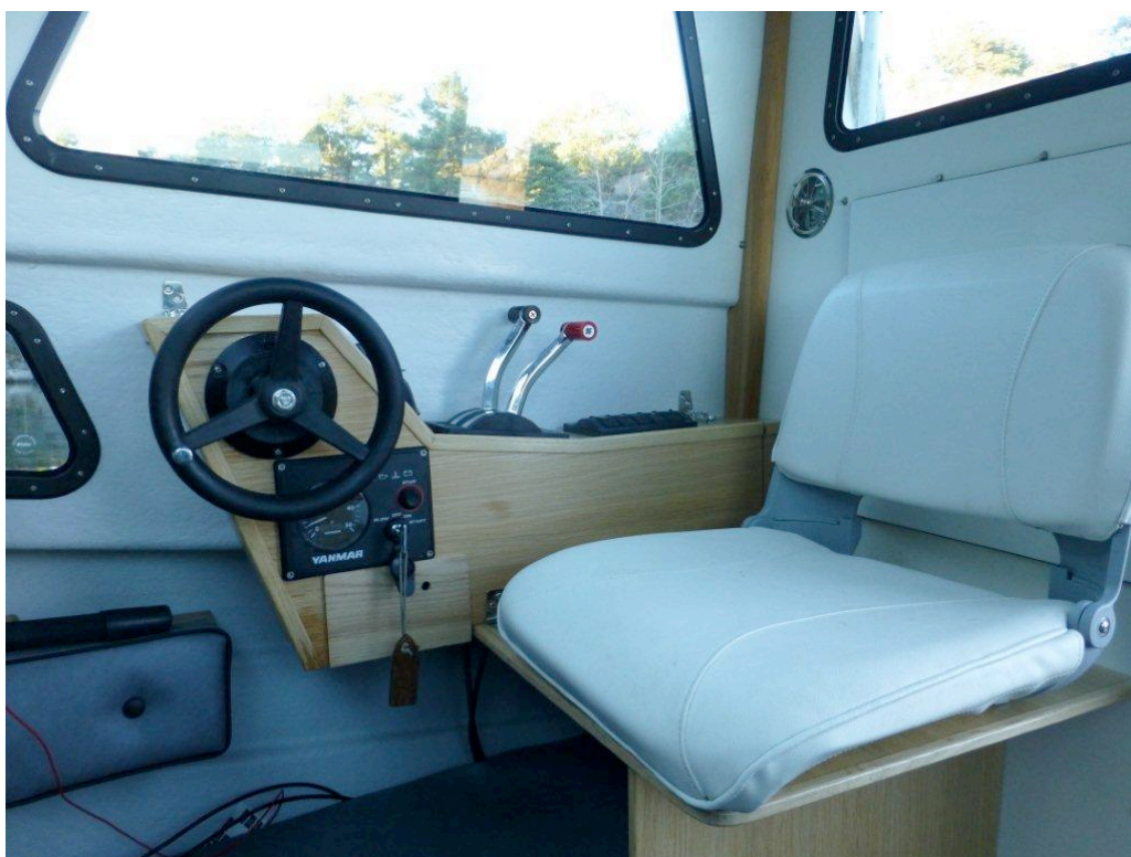
Førerposisjon med sidemontert ratt frigjør mye plass.
